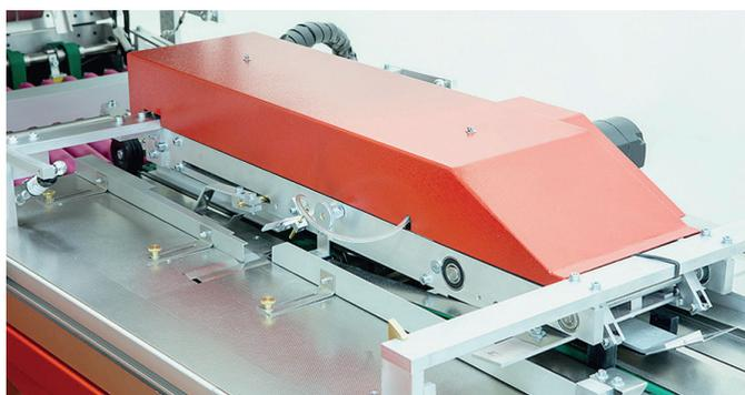
**Falzmodul:** Das Modul wird direkt in das bestehende Transaktionsmodul integriert. Es verarbeitet verschiedene Arten von Dokumenten, wie Einzelblätter, Flyers oder Werbebroschüren, als Zwischenprodukt direkt in die entsprechende Einlagestation - in den Formaten von B6 bis A3.
